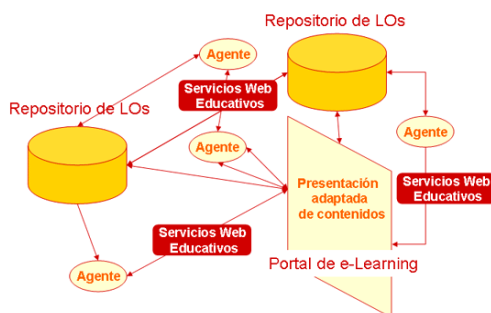
Fig. 4. Presentación de contenidos educativos adaptada al estudiante, a través de los agentes inteligentes y los servicios web educativos.
